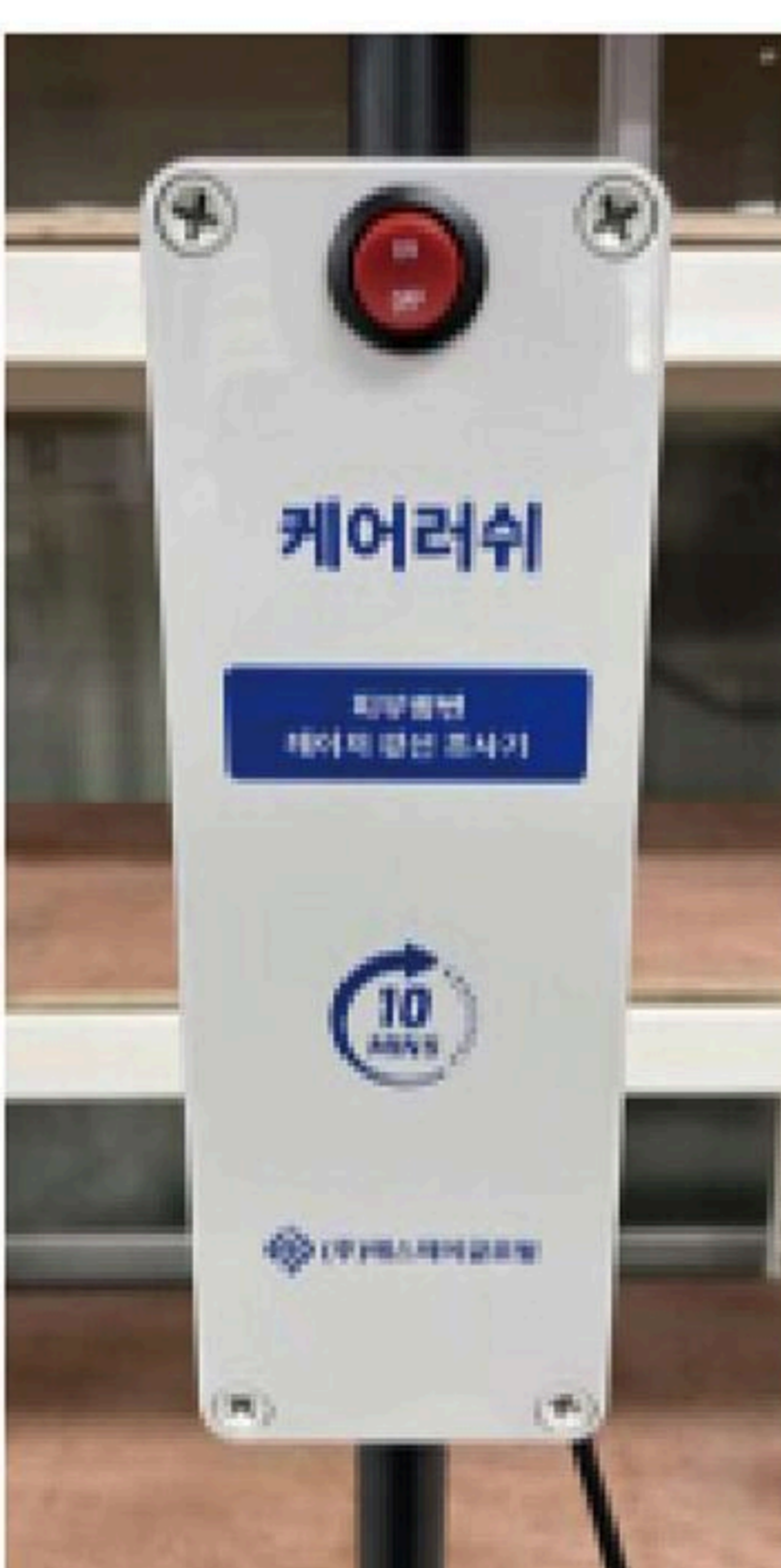
메인전원 입력부 (AC 220V / DC 12V)
